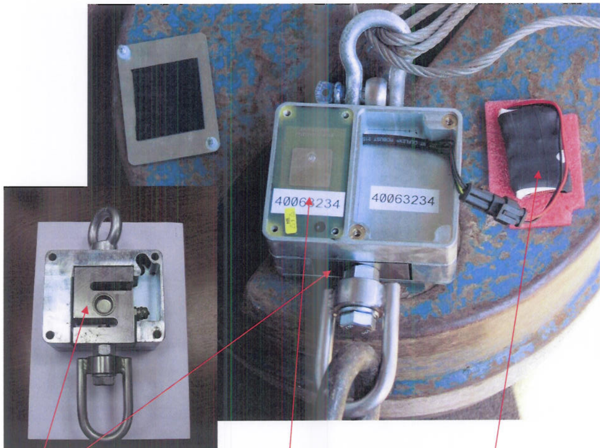
Mjerni pretvornik sile, elektronički sklop za obradu signala i radio modem, napajanje
