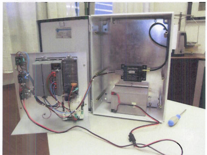
Izgleđ elektroničkog upravljačko pokaznog uređaja i način zaštite natpisne pločice.
